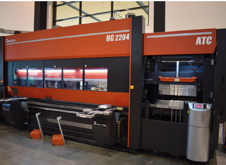
Kantbanken kunnen uitgevoerd worden met een automatisch gereedschapsmagazijn. Dankzij de koppeling met Amada VPSS3i weet de machine welke gereedschappen er gebruikt moeten worden
